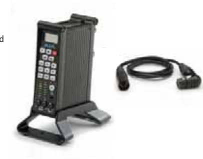
Ki Pro Mini mounted in optional Mini Stand with power adapter cable
